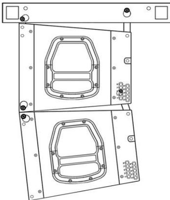
Hardware de vuelo incorporado en el gabinete con diferentes grados de angulación / **Flight hardware incorporated into the cabinet with different angulation grades.**
