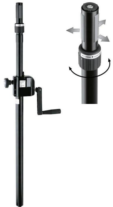
Sistema de expansión patentado »Ring Lock«; conexión sin vibraciones debido a férulas de plástico móviles; sistema de botón y manivela para evitar el movimiento inverso incontrolado; tornillo de bloqueo para seguridad adicional; perno de M20 para un ajuste preciso y vertical.
