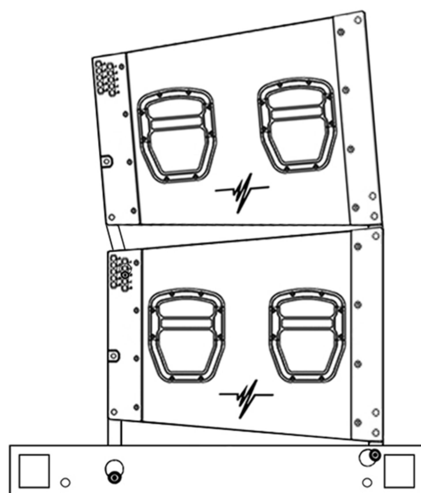
Hardware de vuelo incorporado en la caja con diferentes grados de angulación / Flight Hardware incorporated into the cabinet with different angulation grades.
