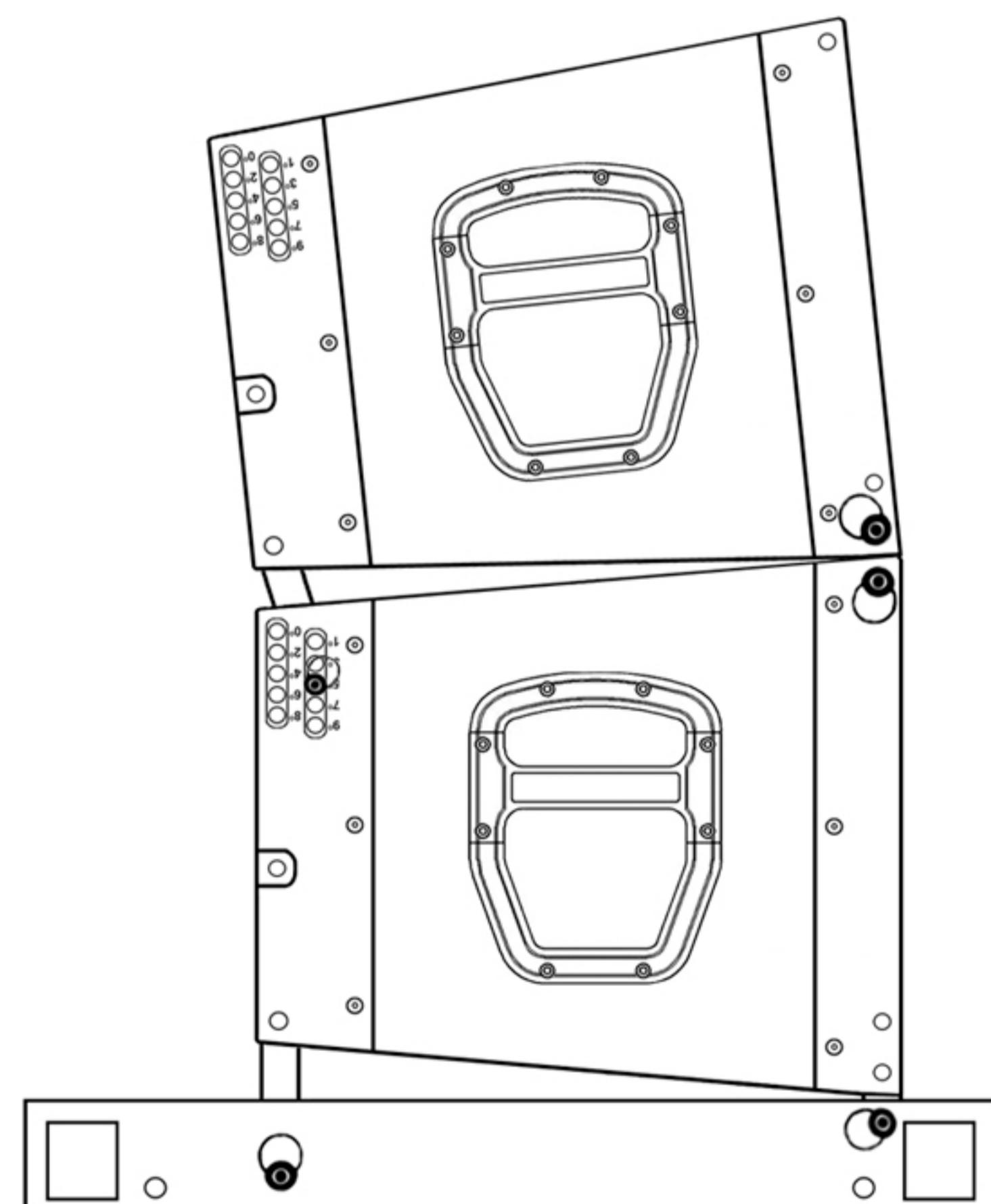
Hardware de vuelo incorporado en la caja con diferentes grados de angulación / Flight Hardware incorporated into the cabinet with different angulation grades.
