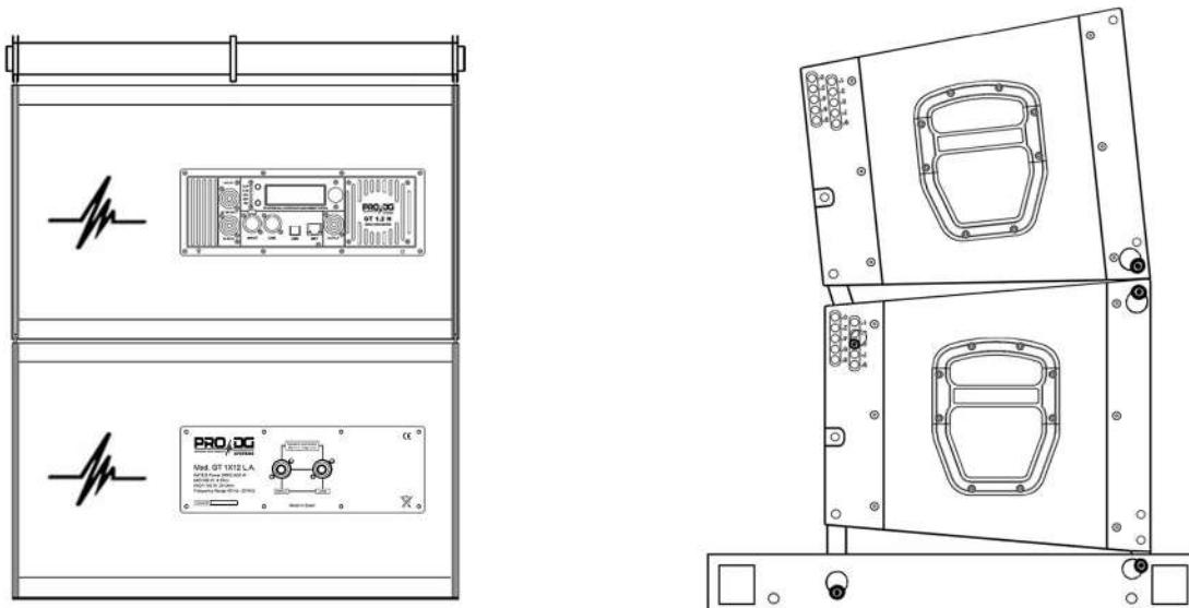
Hardware de vuelo incorporado en la caja con diferentes grados de angulación / **Flight Hardware incorporated into the cabinet with different angulation grades.**
