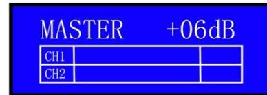
Para navegar a través del menú presione el potenciómetro de ganancia general (5) y gire el mismo a izquierda o derecha para visualizar los submenús detallados a continuación, para acceder a un submenú en concreto presione una vez el potenciómetro (5).
